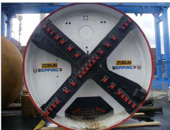
Bild 4: Hydroschild (Bohrdurchmesser 4,40 m) vor der Montage für die Rücklaufstrecke
